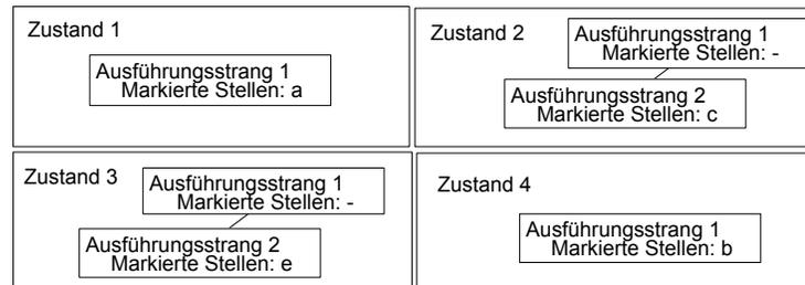
Abbildung 2.10: Ausführungssequenz der Petrinetze *rpn1* und *rpn2*
