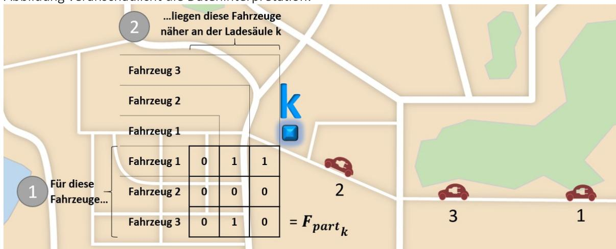
Abbildung 52: Interpretation der Matrix zur Beschreibung der Fahrzeugreihenfolge
