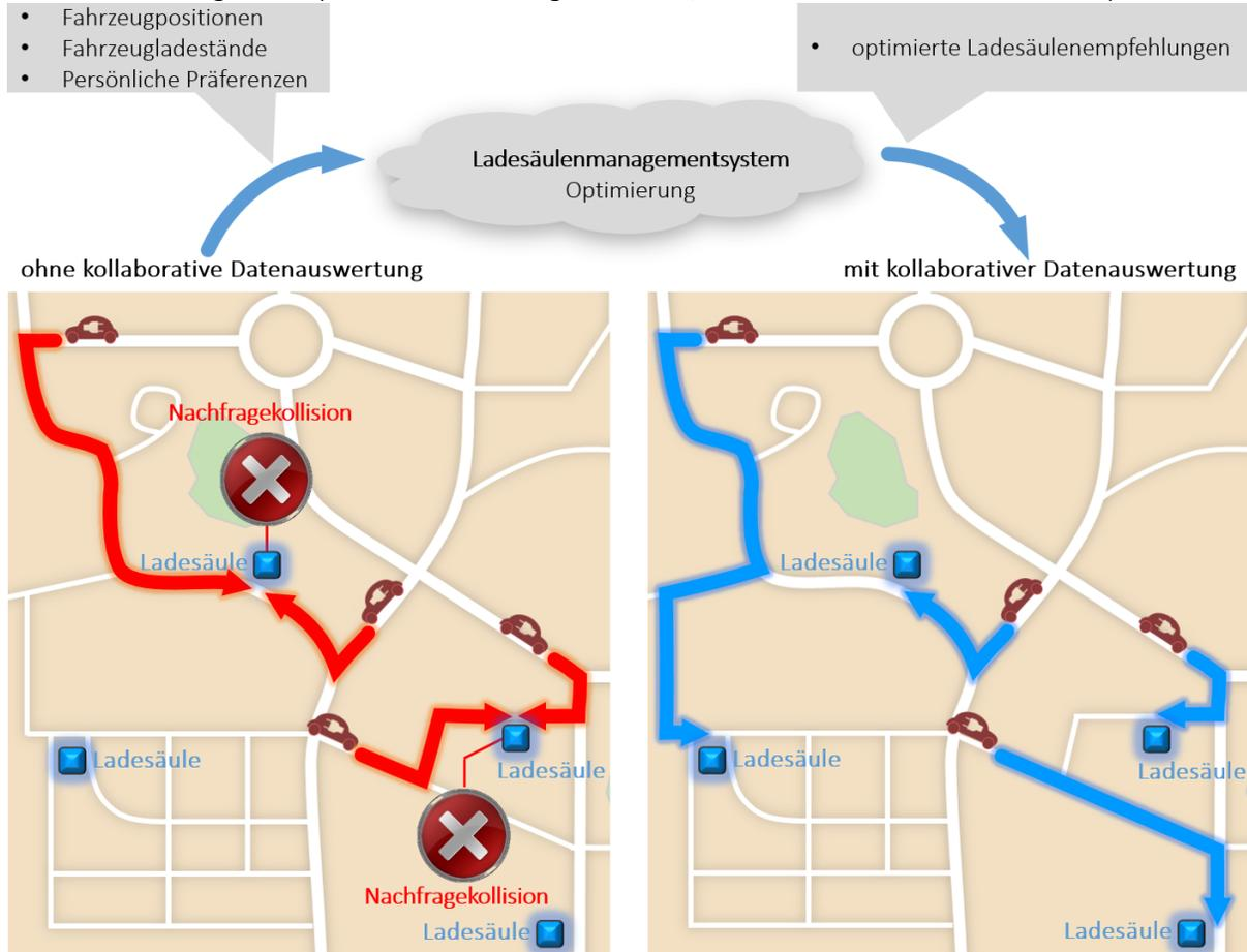
Abbildung 13: Veranschaulichung eines kollaborativen Ladesäulenmanagementsystems
