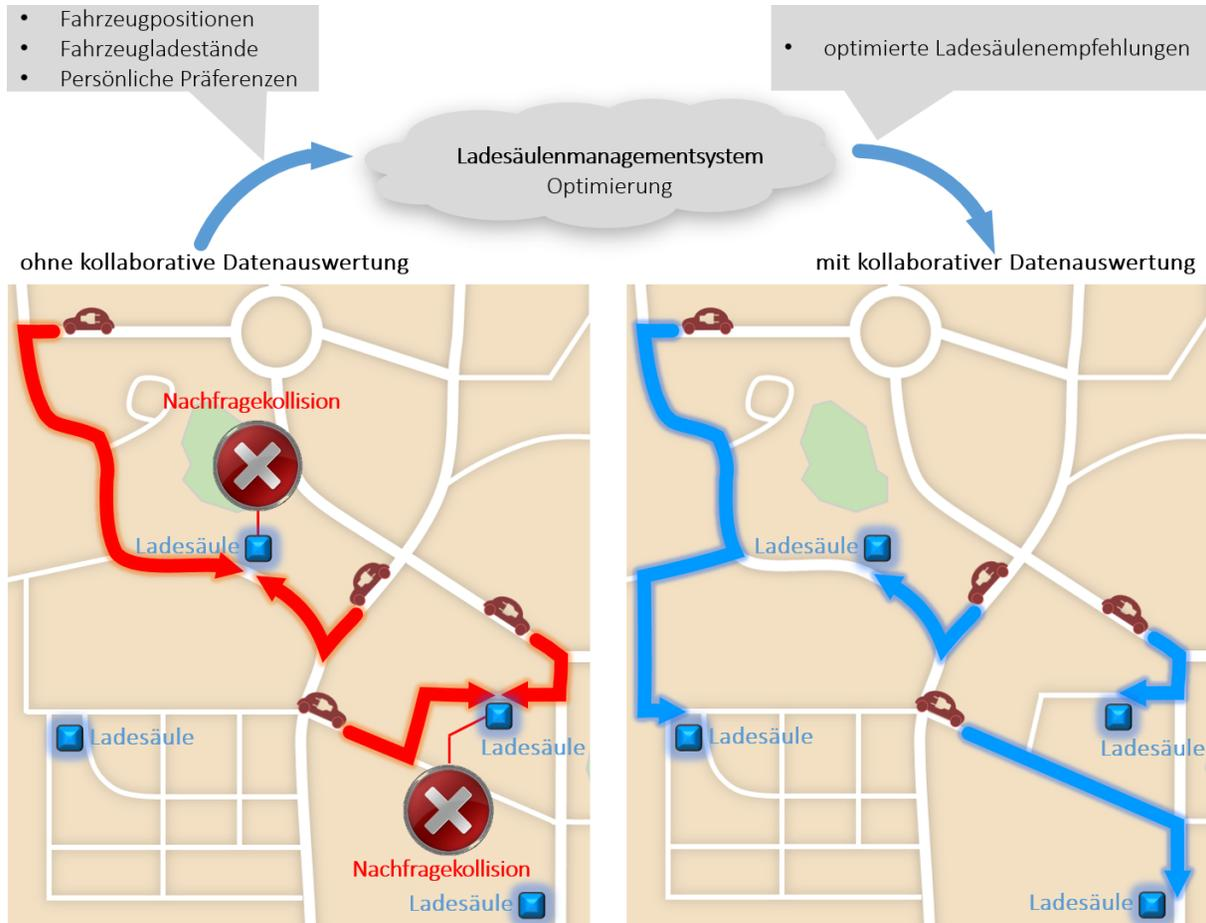
Abbildung 2: Ziel eines kollaborativen Ladesäulenmanagementsystems
